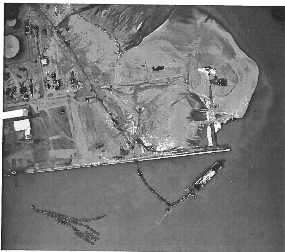
Photo 3 : Dragage hydraulique lors de la construction du secteur portuaire de Beauport - 1969 (source : APQ)
