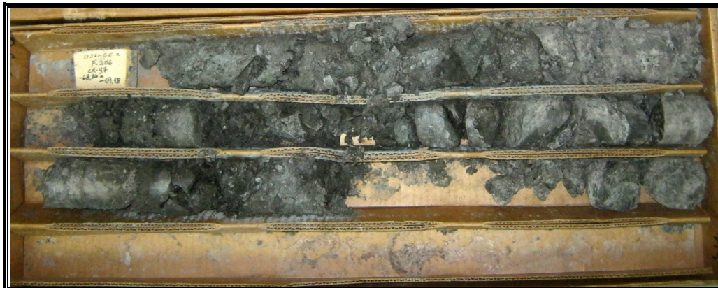
Photographie no A17 : Carottes de roc prélevées dans le forage F-206 (CR-47/-68,36@-69,48m et CR-48/-69,48@-70,36)
