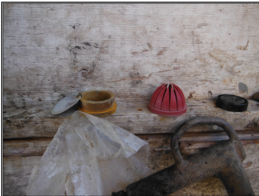
Photographie no E12 : Systèmes de fermeture des cuillères d'échantillonnage: clapet à rabat et coquille.
