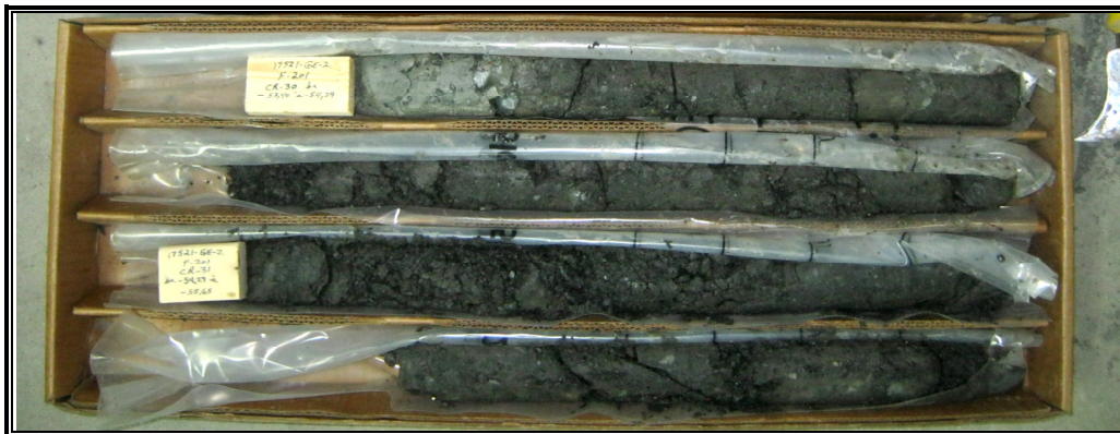
Photographie no A8 : Carottes de roc prélevées dans le forage F-201 (CR-30/-53,40@-54,29m et CR-31/-54,29@-55,17m)
