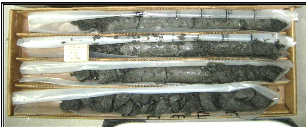
Photographie no A9 : Carottes de roc prélevées dans le forage F-201 (CR-31/-55,17@-55,65m et CR-32/-55,65@-56,97m)
