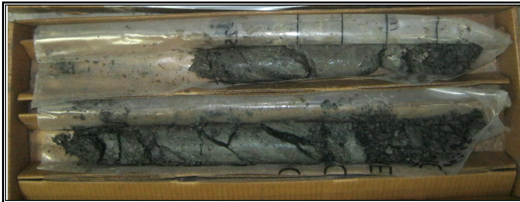
Photographie no A2 : Carottes de roc prélevées dans le forage F-103 (CR-38/-60,94@-61,69m)
