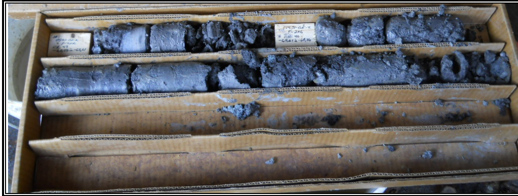
Photographie no A16 : Carottes de roc prélevées dans le forage F-206 (CR-45/-67,29@-67,61m et CR-46/-67,61@-68,36m)
