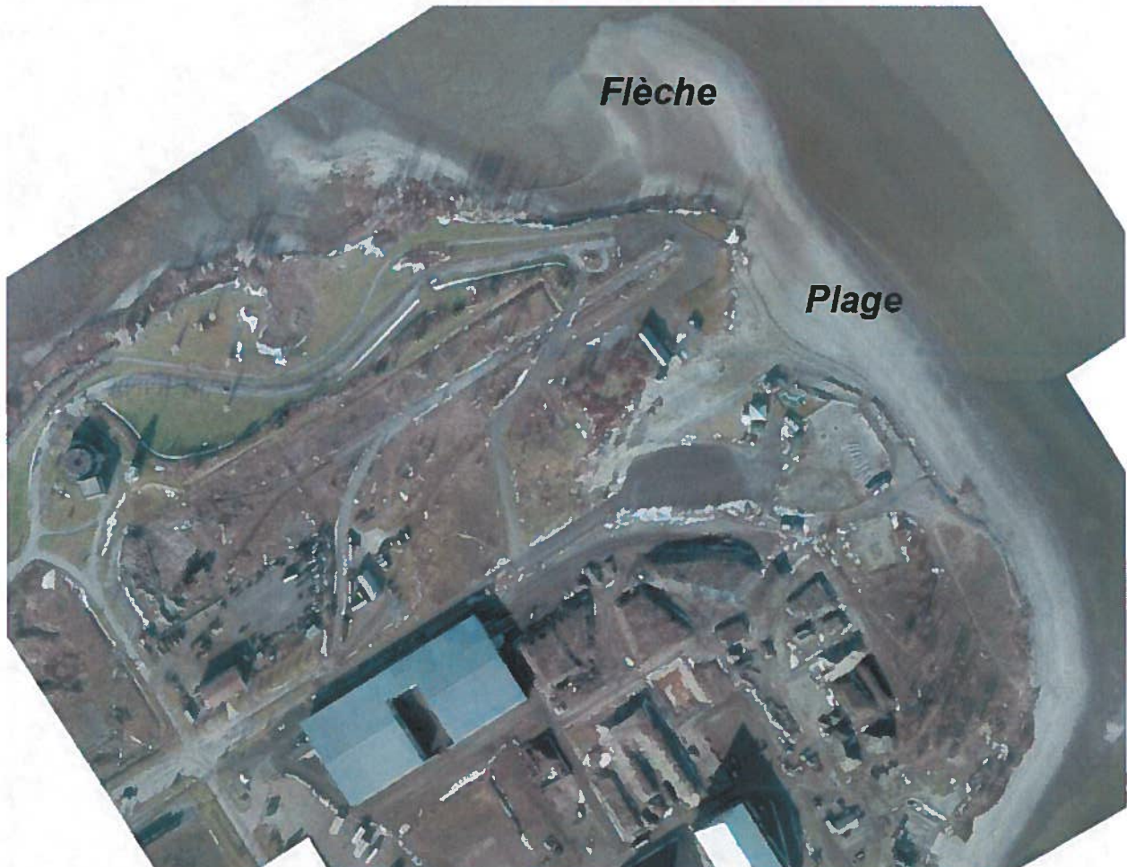
Figure G8 Photo aérienne de 2005 montrant le déplacement des sédiments de la plage vers le rentrant sud-ouest (flèche).
