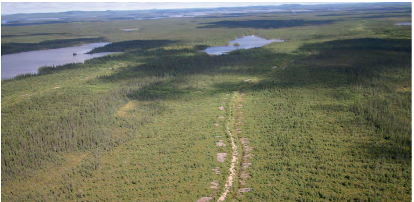
Photo 6 Parc à résidus (option 2 lac Armitage; option rejetée) : le parc occupe toute la partie inférieure de la photo, à droite du lac Armitage (le chemin forestier traverse la partie centrale du parc). Le terrain est techniquement propice à recevoir un amas de résidus mais se trouve à 4-5 km de la fosse et de l'usine et dans un secteur motorisé pour les activités traditionnelles.
